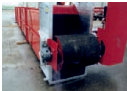
Lieferung und Montage eines Gurtbecherwerkes für Betonwerk
