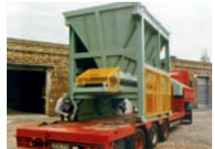
Aufgabebunker für Radladerbefüllung in stabiler Bauweise mit Abzugsband und Schutzeinrichtung
