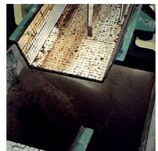
Vibrationsrinne mit Keramikauskleidung
