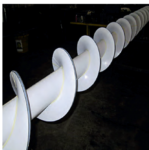
Schneckenbeschichtung für klebrige Materialien
